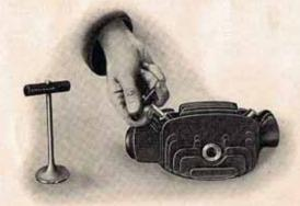
HANDHABUNG DES A.J.S. EINSCHLEIF WERKZEUGES ZUM EINSCHLEIFEN DER VENTILE.
