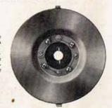
Hat man die Schrauben aus irgend einem Grunde gelöst, achte man darauf, dass die Sicherungen nach dem Einziehen der Schrauben wieder richtig eingesetzt werden.
